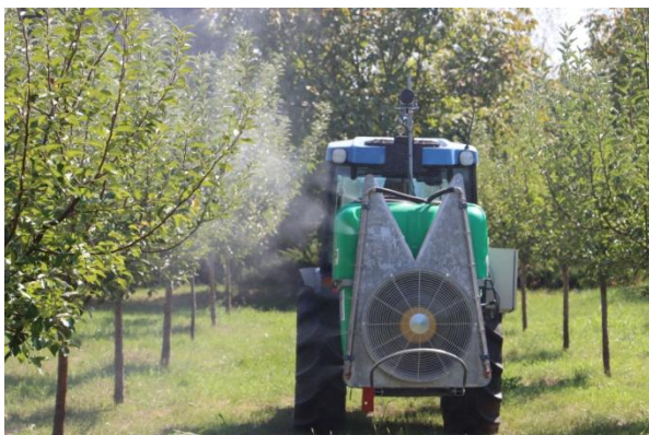
Fig. 5. Echipamentul de stropit dotat cu sistem automat de detectare a caracteristicilor culturii țintă
