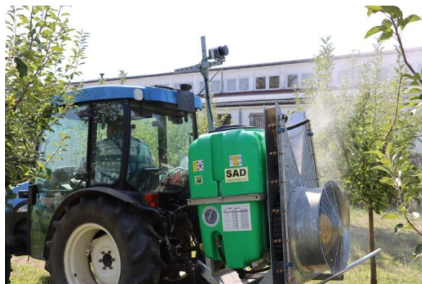
Fig. 5. Echipamentul de stropit dotat cu sistem automat de detectare a caracteristicilor culturii țintă
