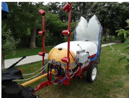
Fig. 4. Echipamentul tehnic pentru aplicarea cu substanțe ecologice și precizie ridicată a tratamentelor fitosanitare în plantațiile pomicole
